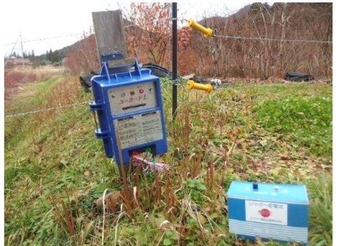
④ 電気柵のバッテリーが切れたので取り換える。暗くなると通電する仕掛けだが今回は1か月もたなかった。畑は電気柵、山はワイヤーメッシュの柵をやむなく設置している。特にシカの被害が多いためだ。
